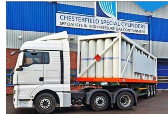
Figure 7 – Camion de livraison Air Products – Hydrogène sous 500 bars
